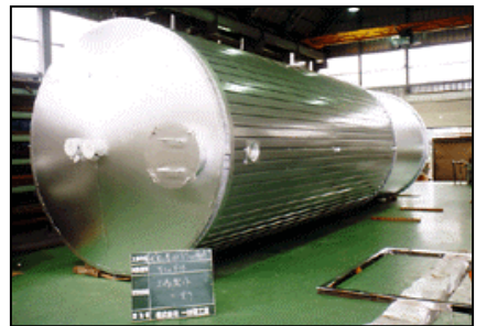
第一製パン金町工場 SS400製粉サイロ 製作・据付
